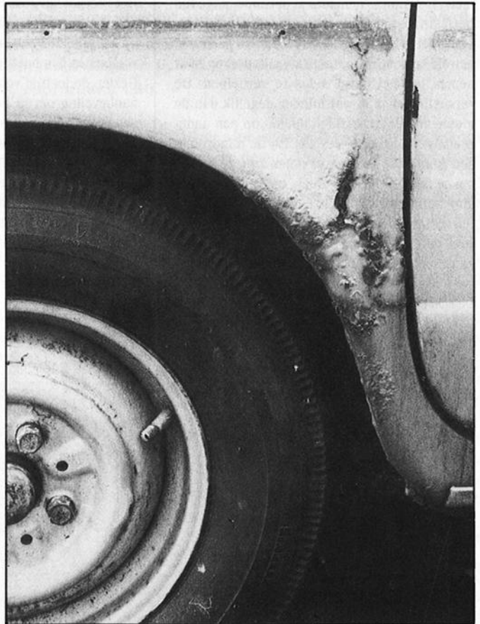
Roest op de achterzijde van het voorspatbord duidt op een slechte (nog onzichtbare) deurstijl.
