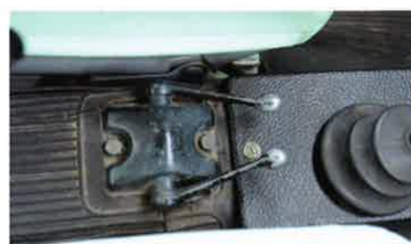
Een hendel om te starten en een hendel voor de choke.
